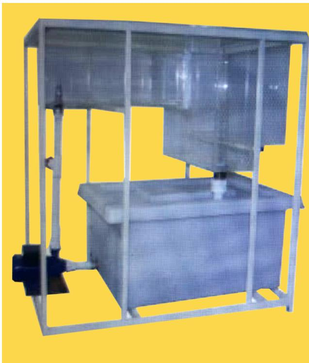
سکوی آزمایش انواع سرریز برای اندازه‌گیری دبی و سایر واحد های مورد نیاز انواع اشکال سرریز، مورد استفاده قرار می‌گیرد. همچنین به عنوان سکو برای سایر دستگاههای آزمایش مانند ضربه جت استفاده می‌شود.
