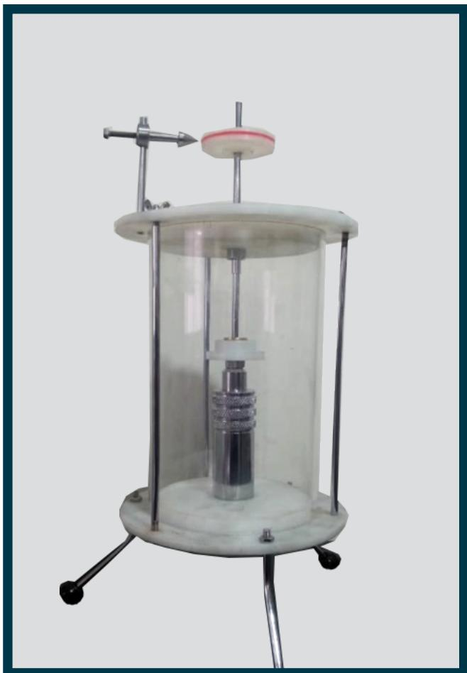
دستگاه اندازه‌گیری نیروی جت آب در آزمایشگاه های مکانیک سیالات جزو اصلی‌ترین وسیله‌های اندازه‌گیری است. اساتید و دانشجویان رشته مکانیک خودرو، ساخت و تولید و کارگاه مدلسازی و ریخته گری به این وسیله نیازمندند.
