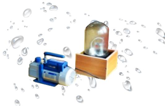
با کاهش فشار هوای بالای سطح مایعات مثل آب، دمای جوش آن ها از دمای جوش استاندارد پایین تر می آید. کاربرد: اساس کار سیستم های برودتی مانند یخچال، کولر و چیلر دستگاه های میوه و سبزی خشک کن
